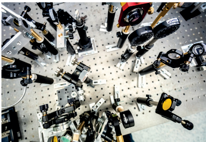
Ukázky experimentálních sestav pro generaci kvantově provázaných stavů na bázi spontánní sestupné parametrické konverze.
