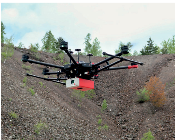
Gama spektrometr D230A (2"x2" NaI(Tl)) v podvěsu dronu DJI M600 KDAIZ, měření v oblasti odvalu š. č. 15 (oblast Příbram, odval ve správě o. z. SUL, DIAMO, s. p.) po těžbě radioaktivního nerostu
