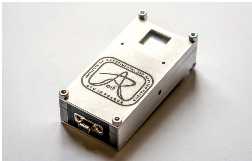
➤ Inženýrský model detektoru HardPix připravený ke kvalifikačním testům nutným pro použití ve vesmíru
