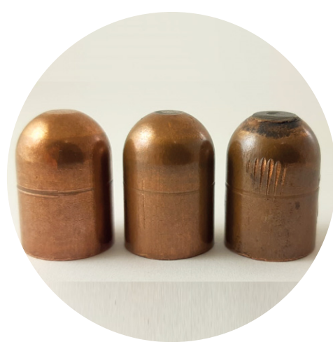
➤ Postupné opotřebení kontaktních ploch elektrod při odporovém svařování. Viditelné změny tvaru a povrchové vrstvy způsobené difúzí prvků z povlakovaného materiálu (např. zinku) vedou ke zhoršení kvality kontaktu, kolísání svařovacích parametrů a následnému zvýšenému výskytu vnitřních vad svarů.
