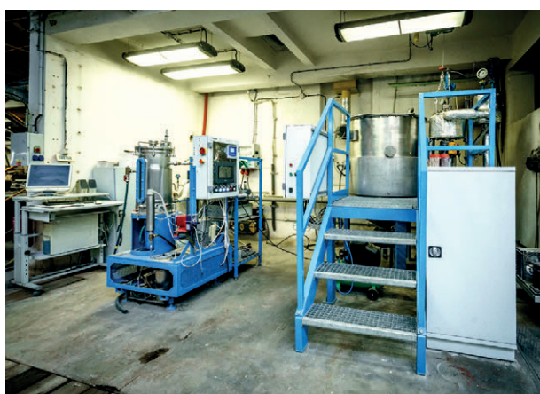
Laboratorní linka zpracování odpadu v konceptu biorafinerie (vlevo bioreaktor, vpravo zařízení pro termicko-expanzní předúpravu odpadu)
