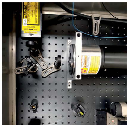
⚡ Aparatura pro měření scintilačního dosvitu s rozlišením asi 70–80 ps. Laser (nahore vlevo) budící rentgenku (vpravo uprostřed), která vyvolává scintilační odezvu vzorku (žlutý bod dole uprostřed). Odezva se měří fotonásobičem s mikrokanálovými destičkami (vpravo dole).
