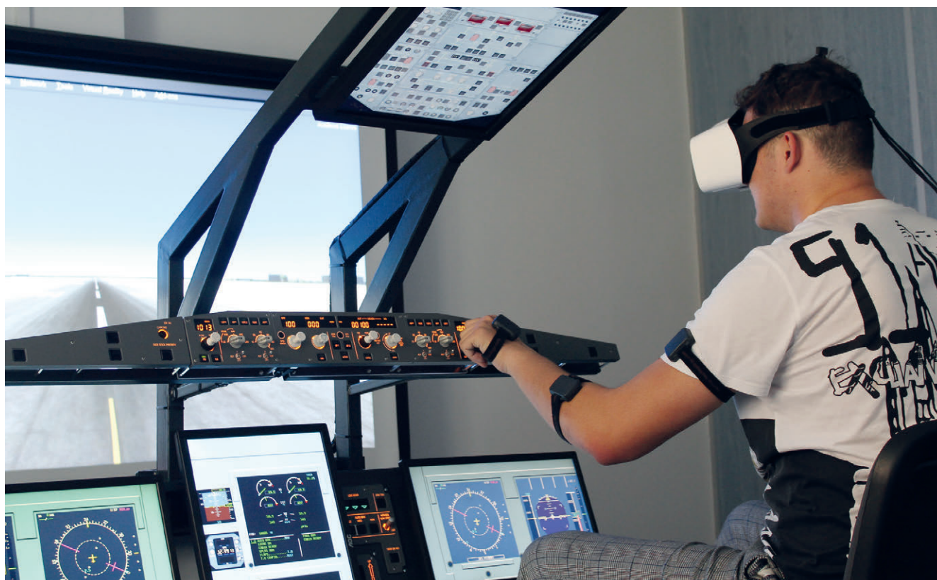
Simulace letu s využitím hardwaru leteckého simulátoru A320 a virtuální realitou pro potřeby měření vizuální percepce s využitím sledování pohybu očí, případně sběru ostatních fyziologických parametrů. [ Foto: Ing. Lenka Hanáková ]
