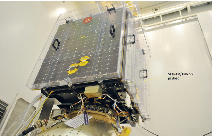
↖ Družice ESA Proba-V při montáži na nosnou raketu Vega-2 v kosmodromu Kourou ve francouzské Gyaně. České zařízení SATRAM/Timepix je integrováno do družice z vnější strany.
