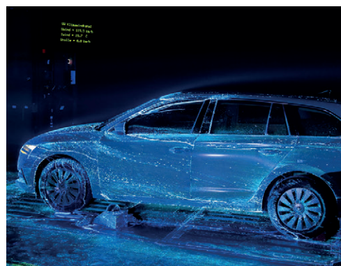
➤ V jedné z posledních fází testování se v aerodynamickém tunelu za pomoci kontrastní barvy ověřuje i to, jak po karoserii při jízdě stéká voda.
