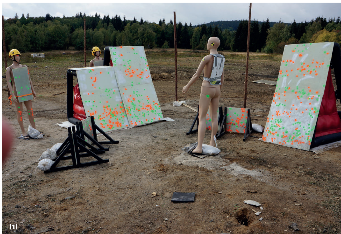
[1] Testování sestavy bariér BALBAR při krizovém scénáři „sebevražedný atentátník“ (figurína postavená zády k objektivu). Figuríny modelující členy bezpečnostních složek jsou označeny žlutými přilbami a stojí za sestavou bariér.
