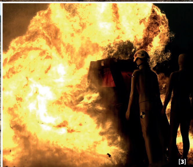
[2] Testování sestavy bariér při krizovém scénáři „velký zášleh plamenem“, jehož zdrojem je výbuch směsi benzínu a nafty před experimentem.
