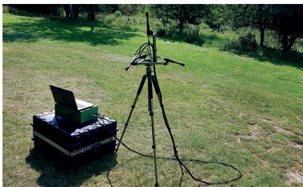
Prototyp akustického detektoru, založeného na čtyřech mikrofonech umístěných v tetraedru připojených přes čtyřkanálový zesilovač k 16bitovému digitizéru. foto: Jakub Svatoš
