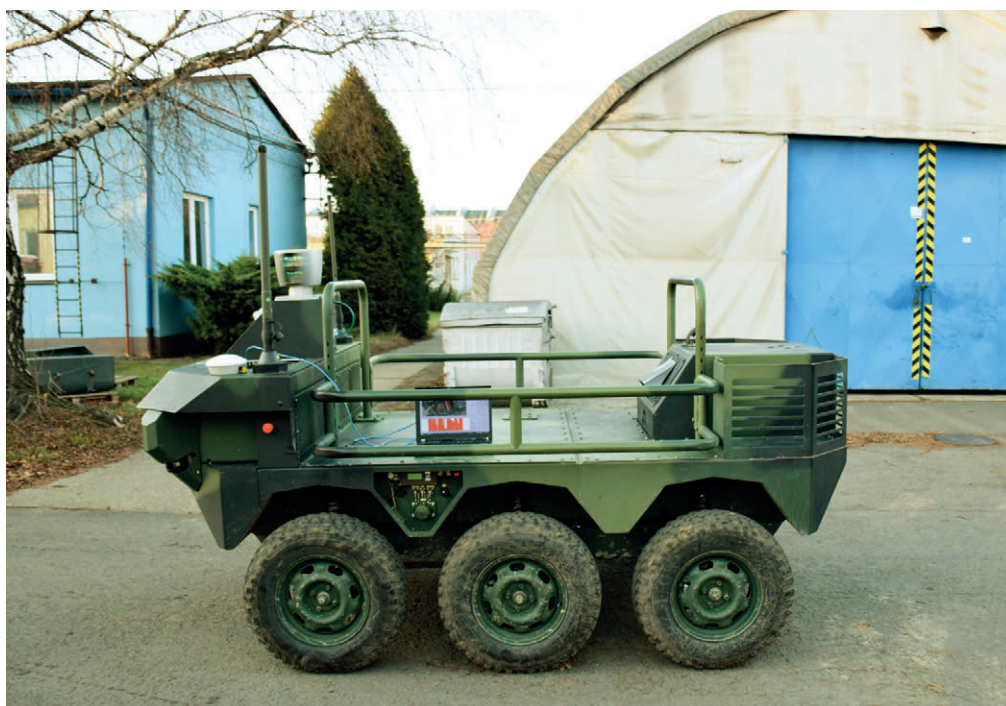
Vozidlo Taros s 3D laserovým dálkoměrem Velodyne.
