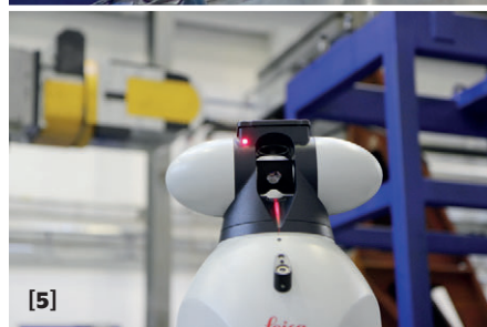
➤ [4] RedCaM – pasivní redundantní kalibrační zařízení s paralelní kinematikou pro měření polohy tělesa v prostoru se šesti stupni volnosti [5] Laser tracker – optické měřicí zařízení [6] Přídavné integrované odměřování změny geometrie obráběcího stroje
