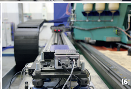
➤ [4] RedCaM – pasivní redundantní kalibrační zařízení s paralelní kinematikou pro měření polohy tělesa v prostoru se šesti stupni volnosti [5] Laser tracker – optické měřicí zařízení [6] Přídavné integrované odměřování změny geometrie obráběcího stroje
