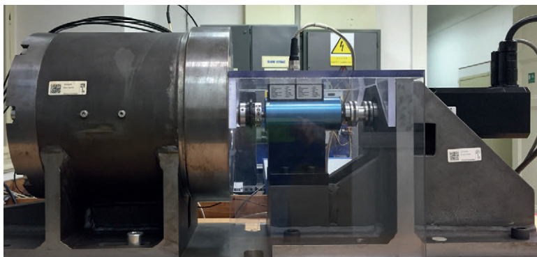
Zařízení pro testování ložisek. Vlevo tubus s ložisky, uprostřed senzor krouticího momentu, vpravo konzola motoru a motor.
