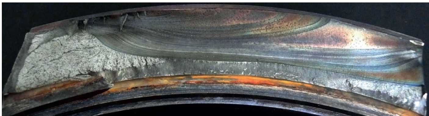
Trhlina v zámku lopatky parní turbíny
