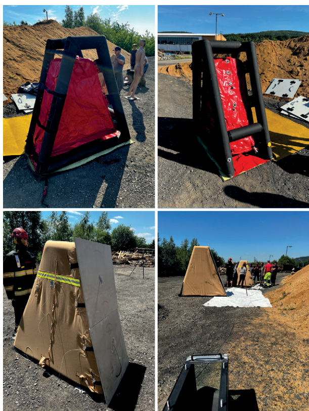
Mobilní balistická bariéra BALBAR při testování bez přehozu, osazením balistických desek a naplnění vodou (nahore). Bariéra BALBAR s poslední variantou přehozu, s naplněným vodním vakem a s osazenými balistickými deskami těsně před zahájením experimentu (dole).
