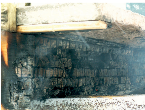
Stropní konstrukce před vybetonováním stropní desky / Zkušební těleso po požární zkoušce
