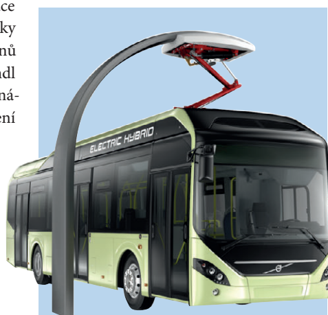
Ukázka z práce zabývající se návrhem pohonu elektrokola. Městský autobus Volvo 7900 Electric Hybrid je kombinací elektrobuse s dobíjením na zastávkách a hybridního autobusu. V centru města může jet v čistě elektrickém módu s dobíjením baterií na vybraných zastávkách, mimo centrum pak v hybridním módu, kdy se rozjíždí ze zastávky jen elektromotorem a vznětový motor startuje až při rychlosti nad 20 km/h.
