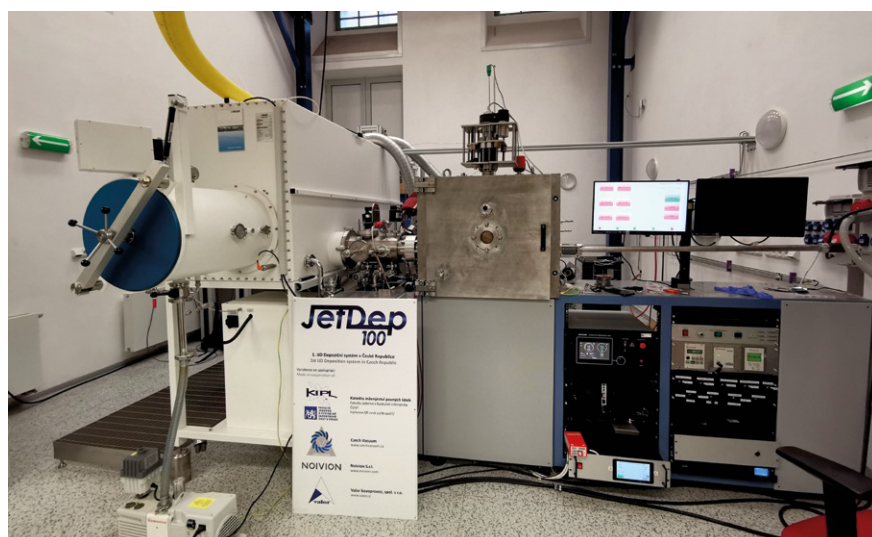
Depoziční aparatura IJD JetDep100 jako součást IJD/ALD depozičního clusteru instalovaného v rámci laboratoří kvantových technologií na KIPL FJFI ČVUT.
