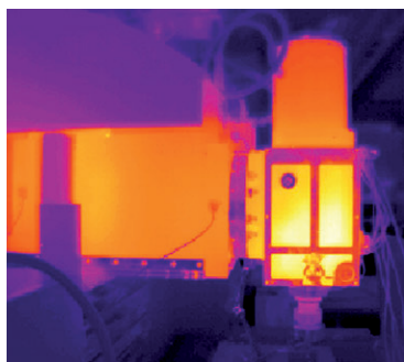
Ukázka termovizní analýzy teplotních vlastností za chodu stroje u partnera
