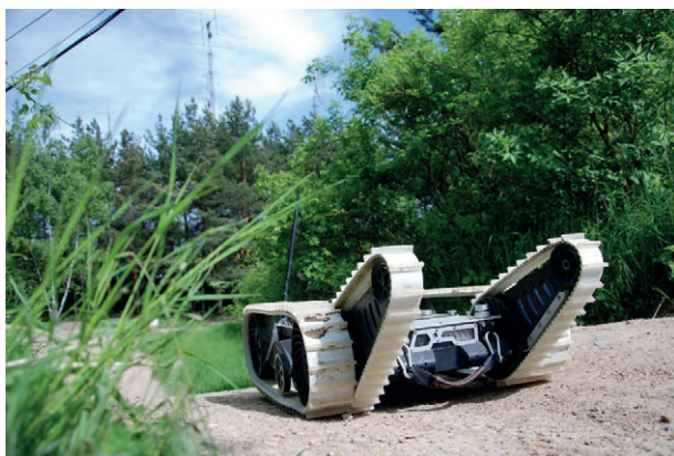
Systém pro 3D rekonstrukci podvozků vozidel (Kerberos) pro účely bezpečnostní inspekce, VOP CZ s.p. [ foto: archiv skupiny IMR ]
