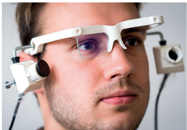
Zařízení pro sledování očních pohybů [ foto: Jiří Ryszawy ]
