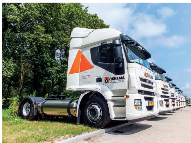
➤ Na snímku vlevo tahač IVECO Stralis s pohonem na LNG, kapacita nádrže 560 l umožňuje dojezd cca 800 km. Vpravo plně flexibilní mobilní LNG plnicí stanice – není třeba žádný vnější zdroj energie, jednoduchá instalace bez dalších investic.
