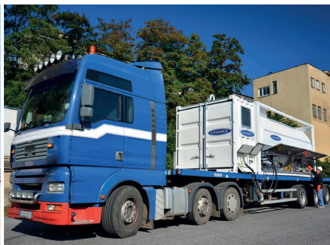
➤ Na snímku vlevo tahač IVECO Stralis s pohonem na LNG, kapacita nádrže 560 l umožňuje dojezd cca 800 km. Vpravo plně flexibilní mobilní LNG plnicí stanice – není třeba žádný vnější zdroj energie, jednoduchá instalace bez dalších investic.
