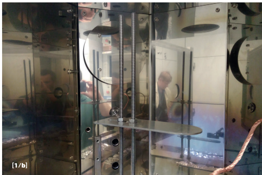
[1/a] Celkový pohled na depoziční komoru [1/b] vnitřní teplotní stínění komory
