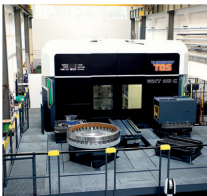
➤ Horizontální vyvrtávací obráběcí centrum WHT 110
