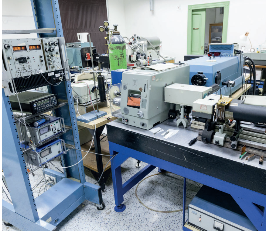
➤ Aparatura pro měření nízkoteplotních emisních a excitačních spekter fotoluminiscence
